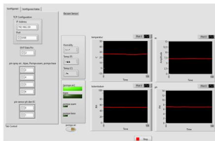
gambar 10 Dashboard utama dan setting pinout
