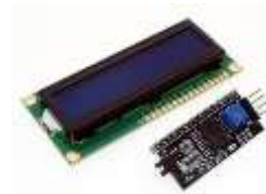
Gambar 5. LCD dan I2C
